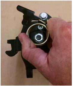
3) REMOVE LEVER (USE PULLER OR ROCKING MOTION AS SHOWN)
